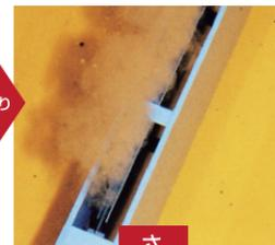
飲料時にはタンクの水を小出水槽に一度入れて、付属の次亜塩素酸製造機で水中の塩素イオンから次亜塩素酸を造ります。小出水槽は透明なので稼働中の様子を目視可能。付属のモニターで設定値にコントロールできます。
